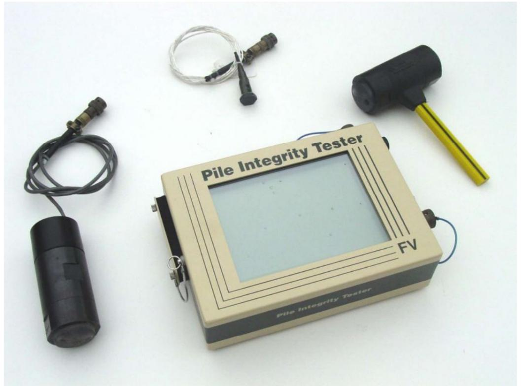
・PITは低応力による衝撃反射式の杭の健全性調査試験方法です。
