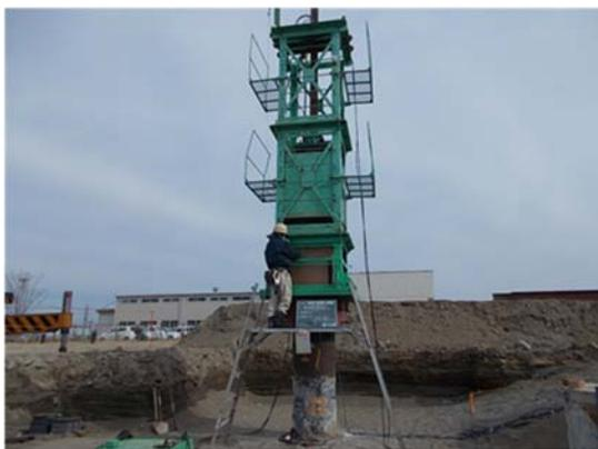
写真1 8t重錘 急速載荷試験装置
