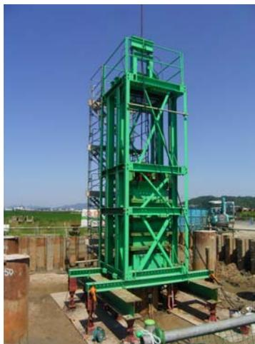
図-1 杭の急速載荷試験装置
