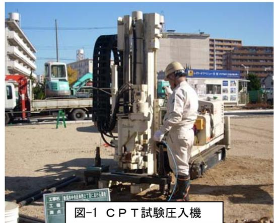
図-1 CPT試験圧入機
