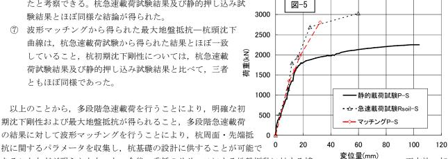
抗に関するパラメータを収集し、杭基礎の設計に供することが可能で あることなどが明らかとなった。今後、重錘のリリースによる地盤振動に対する補 正方法,加 速度計の精度を高める方法、杭急速載荷試験と静的押し込み試験との間、特に降伏以後の沈下量に関する整合性の必要 性や合わせ方、さらに波形マッチングより得られる地盤に関するパラメータの信頼性などについて、引続き研究してゆ く所存である。
