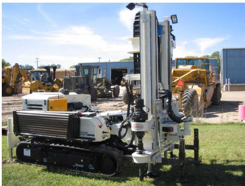
写真2 デモで使用したジオプローブ社の 6625 C P T 及びコードレスコーンシステム
