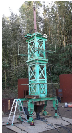
図-1 載荷試験装置
